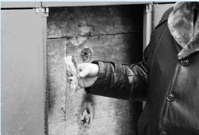
Рис. 2. Огневые испытания утеплителей в навесной фасадной системе:
