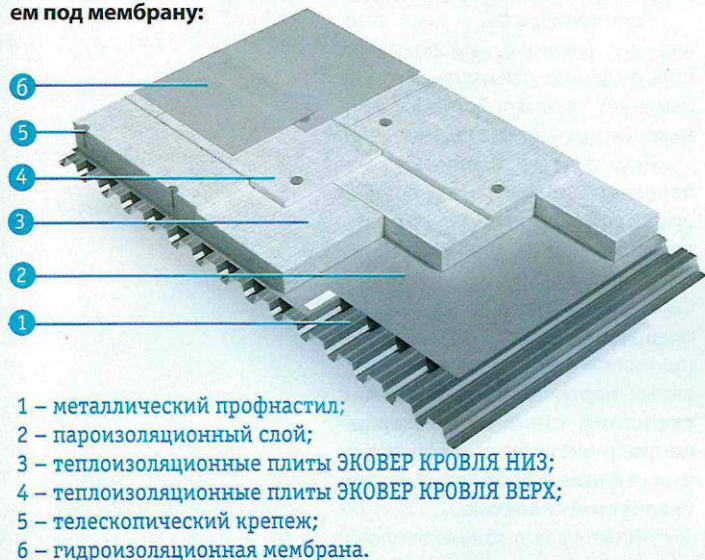
Рис. 2. Конструкция плоской кровли с утеплением под стяжку:
